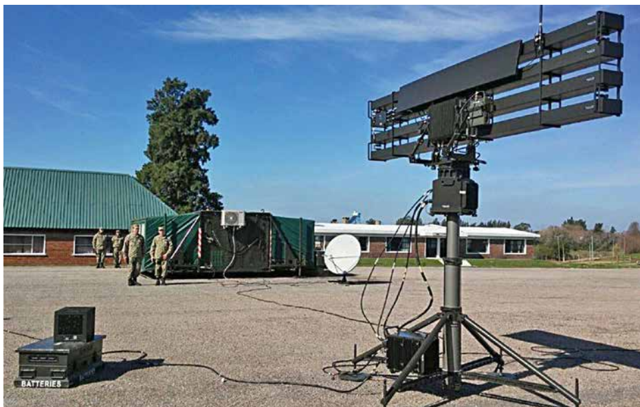
Stacja radiolokacyjna ELM-2106 NG stanowiąca bazę radaru SRL-97 PSR-A Pilica .
