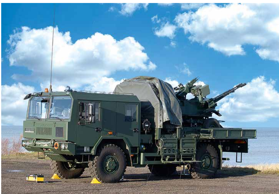
Zamocowanie Jednostki Ogniowej na platformie ładunkowej Jelcza 443.42 okupiono pewnymi kompromisami w zakresie dopuszczalnych kątów ostrzału.
